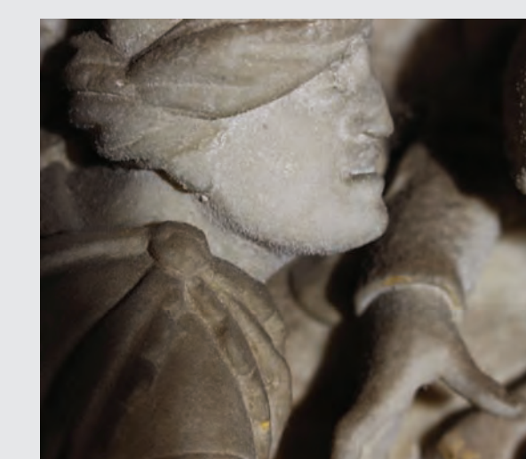
Abb. 12 : Neukristallisation von Gips auf der Alabasteroberfläche | Abb. 13 : Ultraschallmessung am rechten Konsolstein
