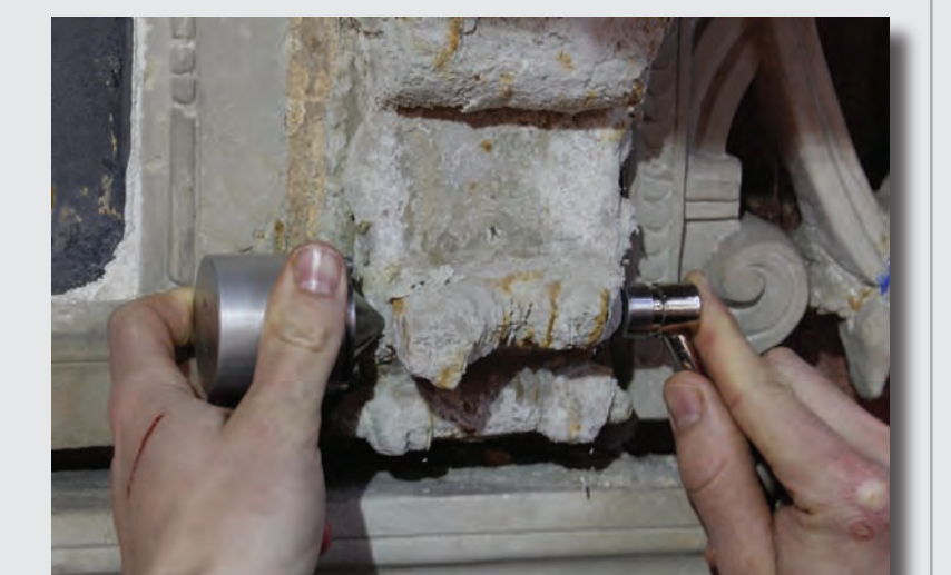
Abb. 12 : Neukristallisation von Gips auf der Alabasteroberfläche | Abb. 13 : Ultraschallmessung am rechten Konsolstein
