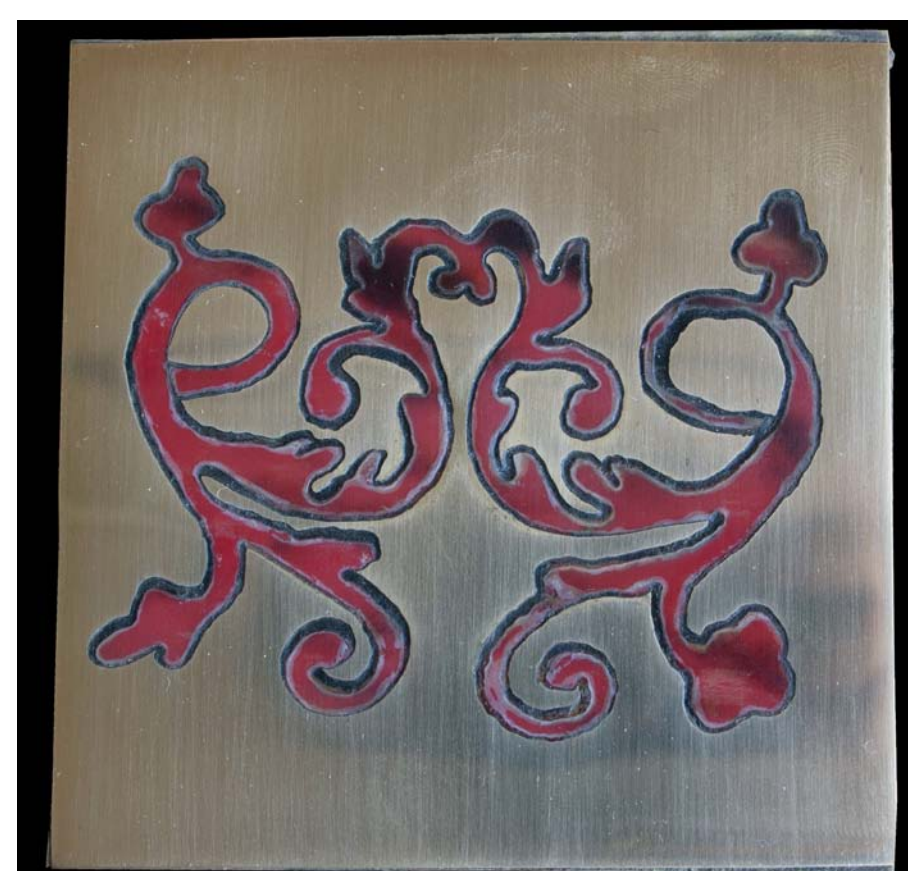
Draufsicht auf contre partie nach Klimaschrank
