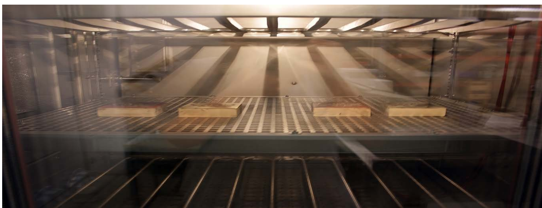
Probetafeln in Boulle-Technik im Klimaschrank
