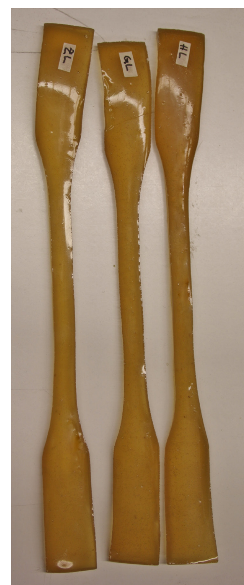
Hergestellte Leimprüfkörper aus modifizierten Leimen
