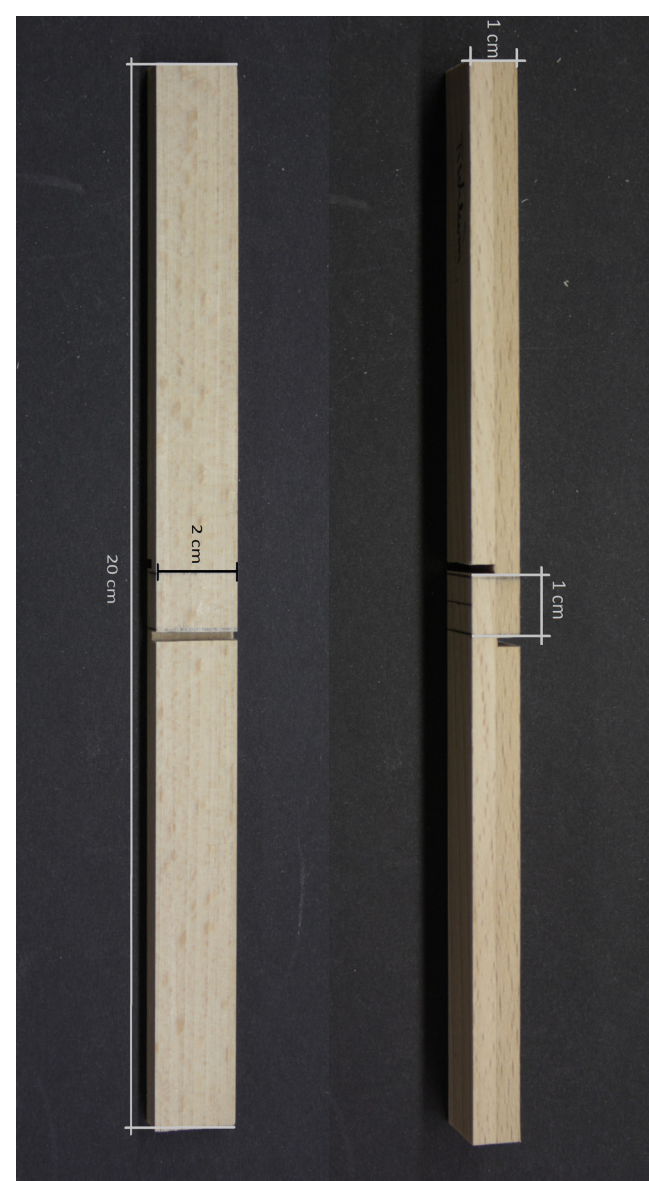
Angefertigter Prüfkörper aus Buchenholz für den Zug-Scherversuch
