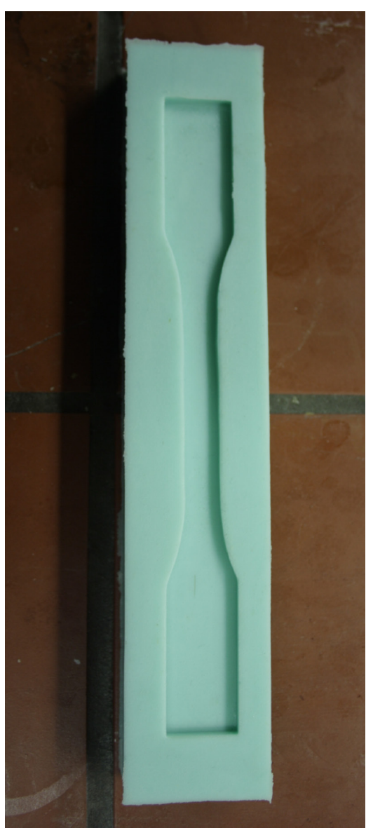
Fertige Silikonform zur Herstellung von Leimprüfkörpern
