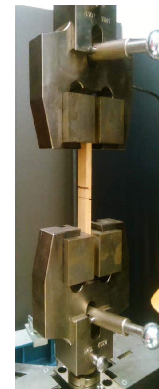
Eingespannter Prüfkörper im Zug-Scherversuch
