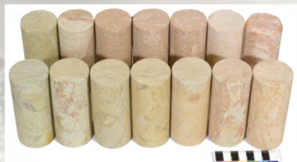
Abb. oben: Probekörper aus Postaer Sandstein (Temperaturstufe 1000°C) nach Messung der Druckfestigkeit. Abb. unten: Probekörper aus Cottaer (Reihe unten) und Postaer Sandstein (Reihe oben), Temperaturstufen (von links nach rechts): 25, 400, 500, 600, 700, 800, 1000 °C.
