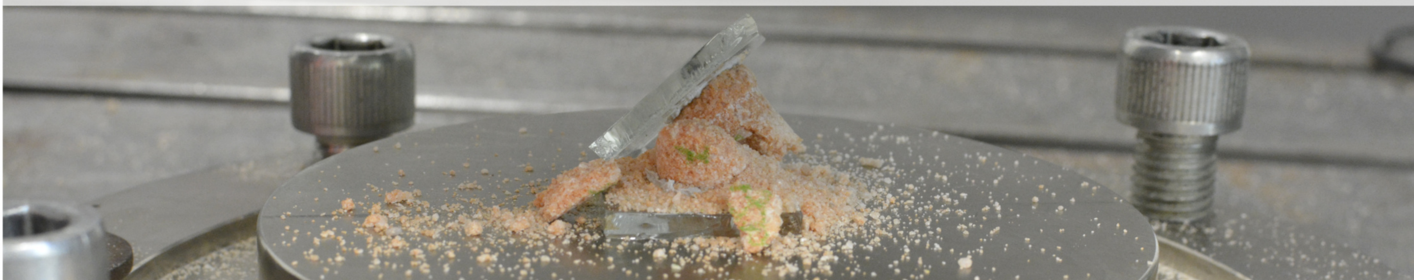
Abb. oben: Probekörper aus Postaer Sandstein (Temperaturstufe 1000°C) nach Messung der Druckfestigkeit. Abb. unten: Probekörper aus Cottaer (Reihe unten) und Postaer Sandstein (Reihe oben), Temperaturstufen (von links nach rechts): 25, 400, 500, 600, 700, 800, 1000 °C.
